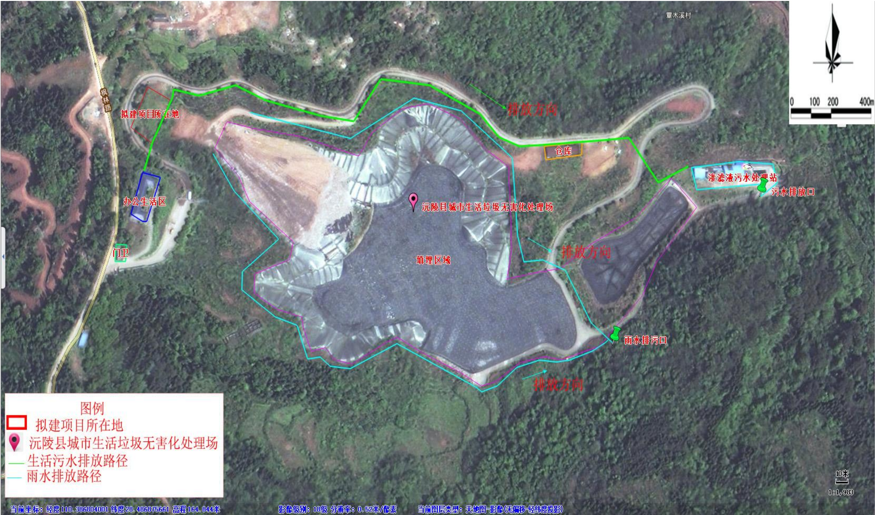
附图 4：沅陵县城镇生活垃圾填埋场总平面布局图及雨污管网路径图
